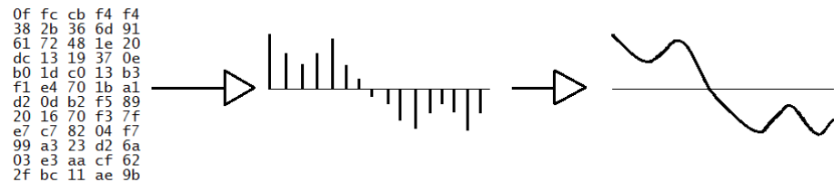
Figura 3. La modulación de impulsos codificados hacia la señal digital hacia la cadena de señal analógica
